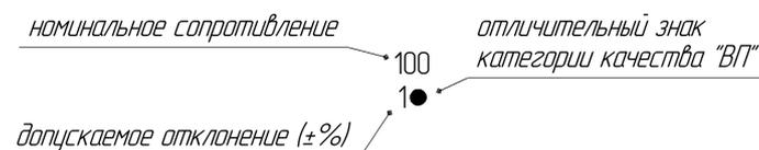
\* Резисторы P1-17-10-1, P1-17-10-3 не маркируют. Допускается маркировка резисторов по фланцу.
